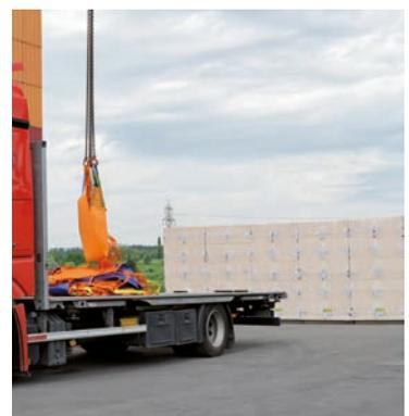
Die swisspor AG hat das im Jahre 2004 eingeführte Entladesystem „BIG MAMMA“ überarbeitet, weiterentwickelt und verbessert. Dadurch wird dem Art. 6' der Kranverordnung, gestützt auf das Unfallversicherungsgesetz (UVG), nun ausnahmslos Rechnung getragen. Hierzu wird neu die zu hebende Last mit einem speziell entwickelten Netz zusammengehalten und gesichert.
