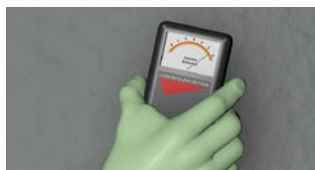
Untergrundprüfung gemäss SN 640 450
