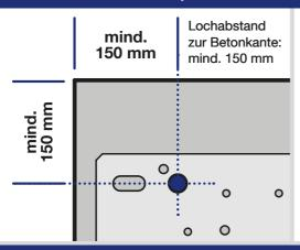
Mit ø 10 mm Schlagbohrer mind. 90 mm tief bohren
