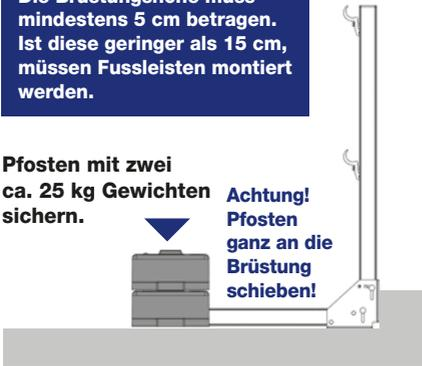
Beim Befestigen der Schraube am Gewicht unbedingt darauf achten, dass die vorhandene Abdichtungsebene nicht beschädigt wird!
