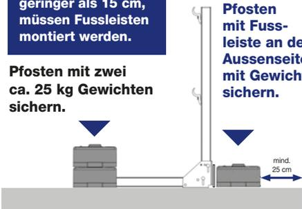
Beim Befestigen der Schraube am Gewicht unbedingt darauf achten, dass die vorhandene Abdichtungsebene nicht beschädigt wird!
