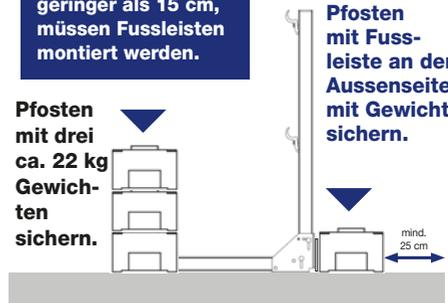
Beim Befestigen der Schraube am Gewicht unbedingt darauf achten, dass die vorhandene Abdichtungsebene nicht beschädigt wird!
