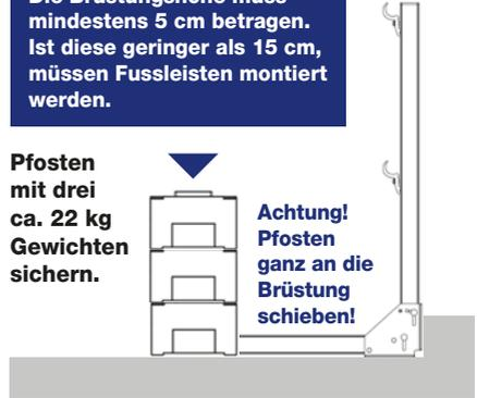
Beim Befestigen der Schraube am Gewicht unbedingt darauf achten, dass die vorhandene Abdichtungsebene nicht beschädigt wird!
