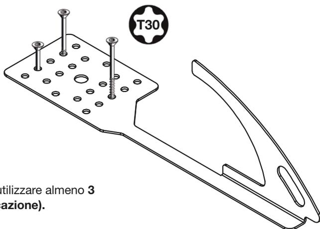
Con DH e DHB Plus utilizzare almeno 3 viti (esempio d'applicazione).
