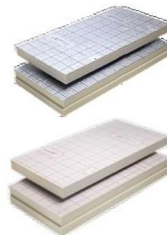
Es handelt sich dabei um steife Platten, die an Dächern (Flach- oder Steildach) oder Böden (unter Unterlagsboden/Estrich) eingebaut werden. Die Wärmeleitfähigkeit der Dämmstoffplatten liegt zwischen 0.022 W/(m·K) und 0.027 W/(m·K).
