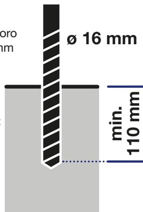
Spessore minimo del sottofondo: 160 mm
