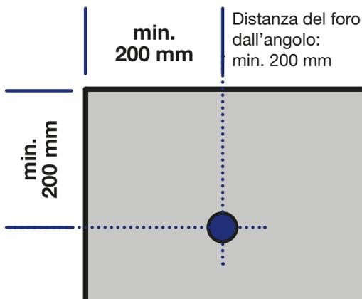
Con trapano a percussione  $\varnothing$  16 mm eseguire un foro di min. 110 mm di profondità
