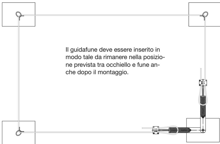
Nei sistemi a fune continua, gli ammortizzatori di caduta devono essere montati su un punto d'angolo/di inizio. I guidafune sono disponibili con un angolo di 45°, 90° e 130°.
