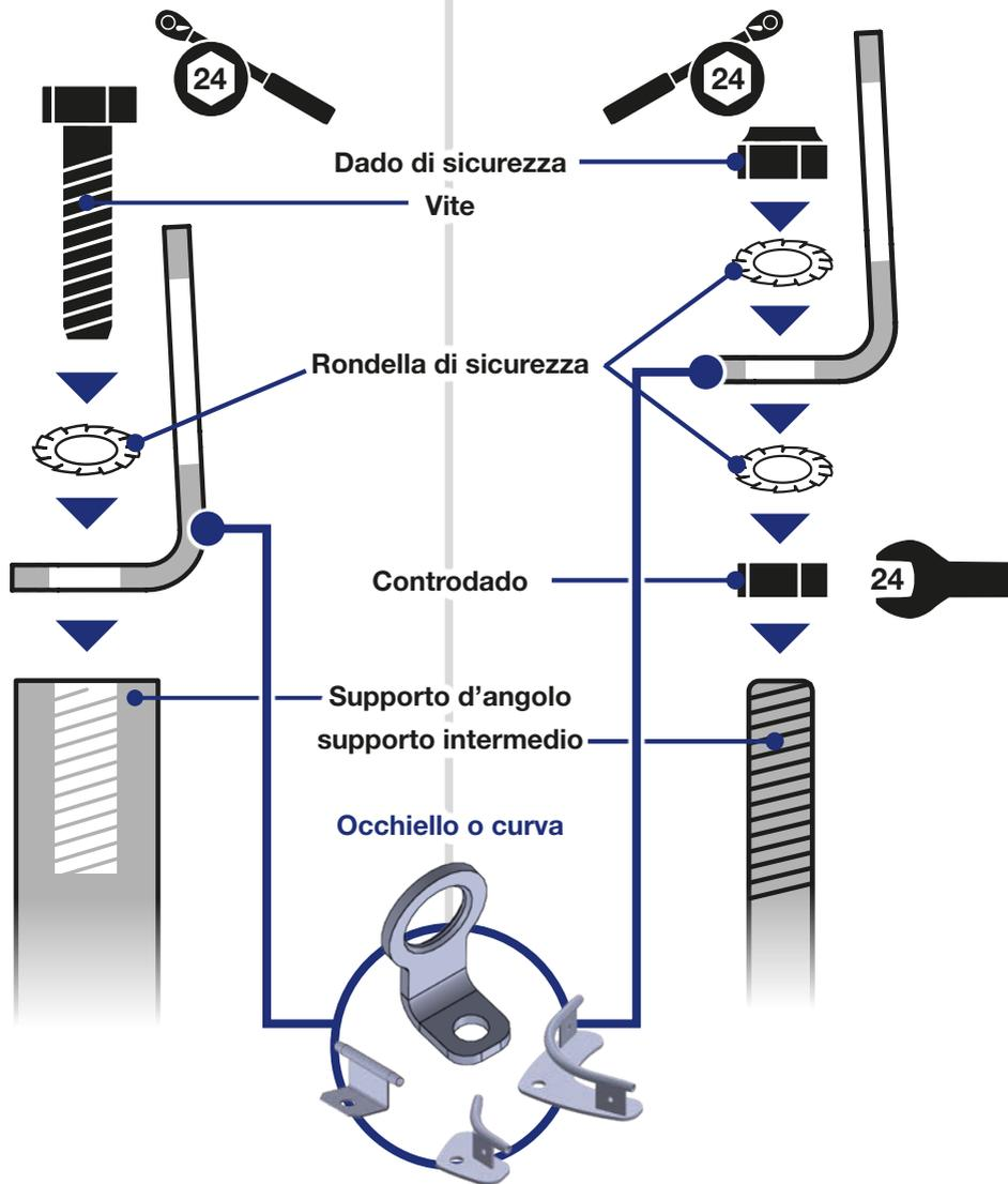
! Proteggere la filettatura applicando della pasta al rame o lo spray contro la saldatura a freddo dell'acciaio. !
