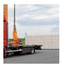
Die swisspor AG hat das im Jahre 2004 eingeführte Entladesystem "BIG MAMMA" überarbeitet, weiterentwickelt und verbessert. Dadurch wird dem Art. 6¹ der Kranverordnung, gestützt auf das Unfallversicherungsgesetz (UVG), nun ausnahmslos Rechnung getragen. Hierzu wird neu die zu hebende Last mit einem speziell entwickelten Netz zusammengehalten und gesichert.
